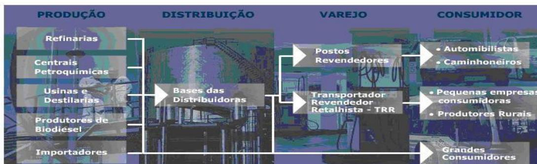
**Figura 6: A cadeia de suprimentos dos combustíveis**
