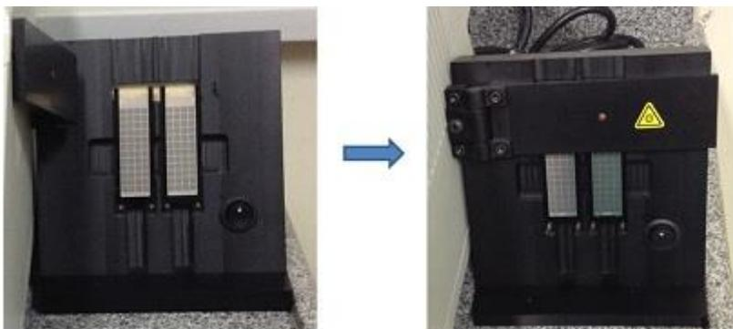
**Figura 9.** Foto da selagem das cases na estação de selagem.
