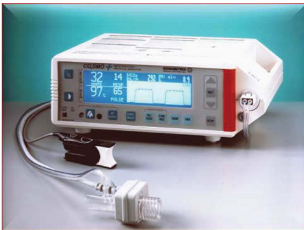
Figura 7: Equipamento CO 2 SMO-Plus® DX-8100, Novamatrix, Medical Systems, USA, trata-se de um monitor não invasivo constituído de capnógrafo, pneumotacógrafo e oxímetro de pulso. No monitor são conectados os seguintes sensores: de CO 2 , de fluxo e de oximetria de pulso.
