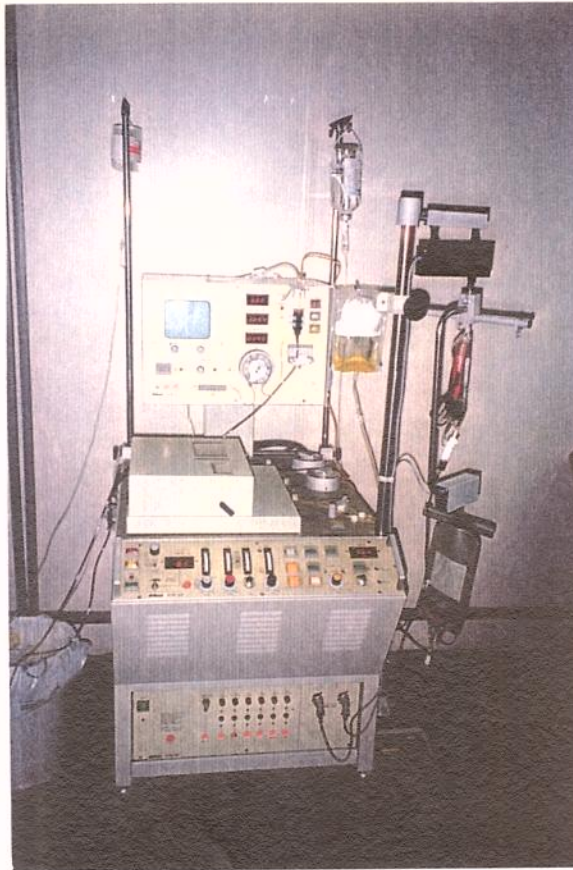
figura 1: equipamento Dideco Vivacell modelo BT 798 CE/A utilizado para a realização de procedimentos de eritrocitaférese terapêutica
