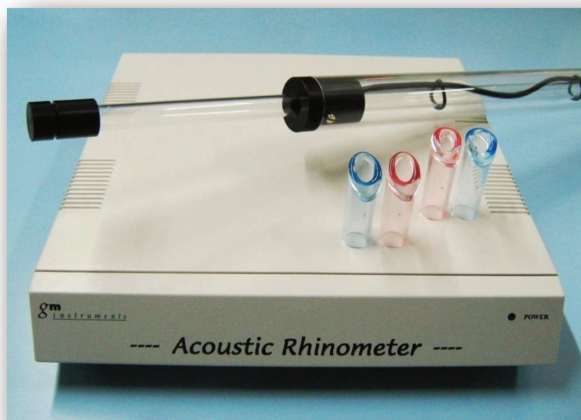
Figura 5: Equipamento de rinometria acústica (marca “GM Instruments”, modelo “Acoustic Rhinometer”) utilizado no monitoramento da provocação nasal a partir do registro dos dados de AST-2.
