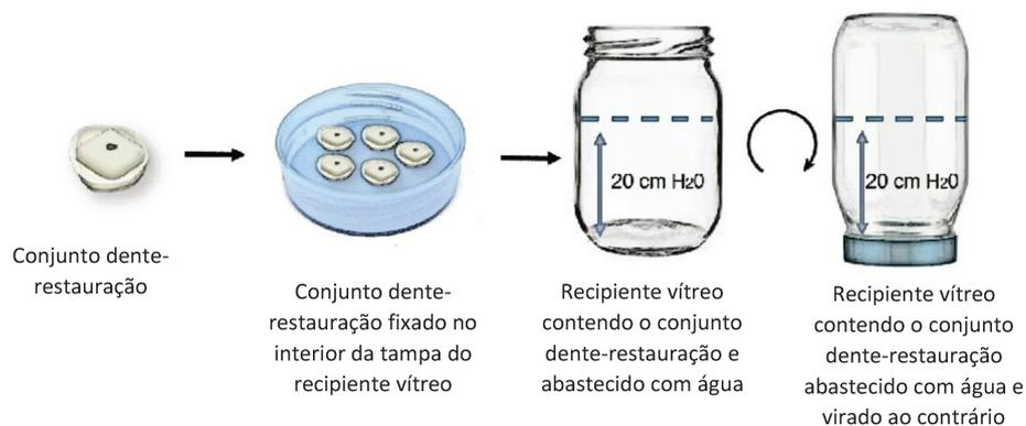
**Figura 07.** Ilustração esquemática da simulação da pressão pulpar
