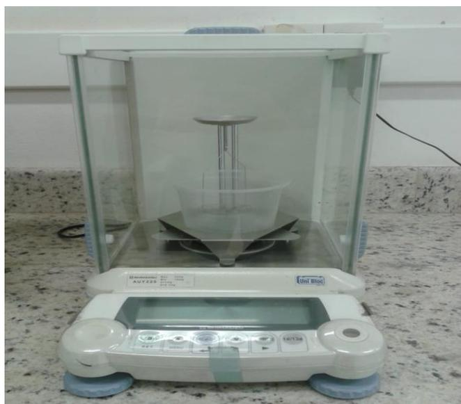
Através desse kit foi possível medir a densidade aparente do material pelo princípio de Arquimedes. Para tal, as amostras, primeiramente, devem ficar imersas em água destilada por 8 horas, com o objetivo de ocupar todos os poros presentes no material. Após esse procedimento, o excesso de água da amostra é removido com um papel e a massa da amostra úmida ( $m_u$ ) é medida. Na sequência, a massa
