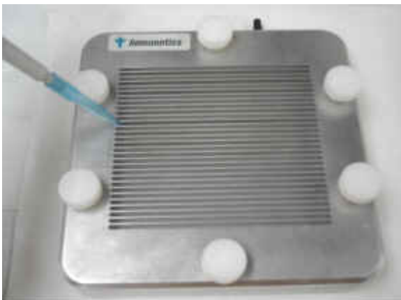
Figura 5a: Carregamento das amostras por sobre a membrana de nylon no mini-slot.
