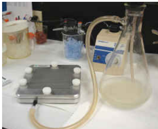
Figura 5b - Ativação do vácuo para a absorção das amostras pela membrana.
