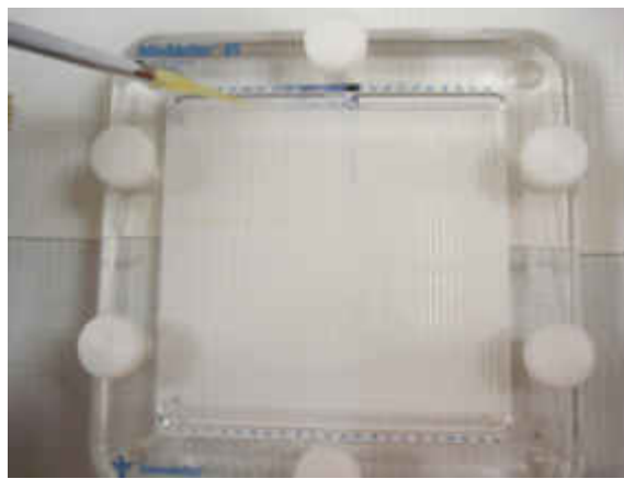
Figura 7 - Carregamento das sondas no miniblotter
