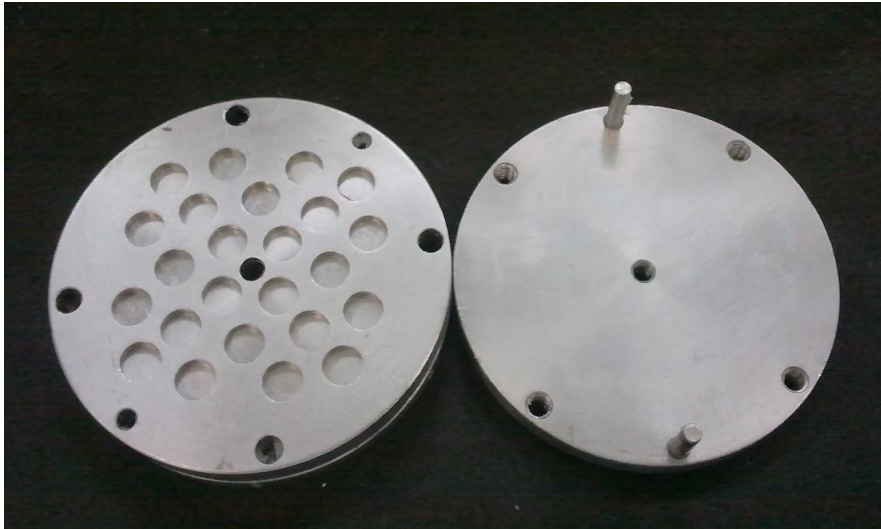
Figura 2 – Mufla de aço inox para confecção dos espécimes
