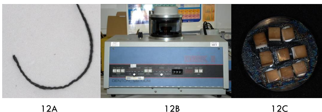
Fig. 12. A - Corda de carbono; B - Metalizador; C – Amostras recobertas com carbono.
