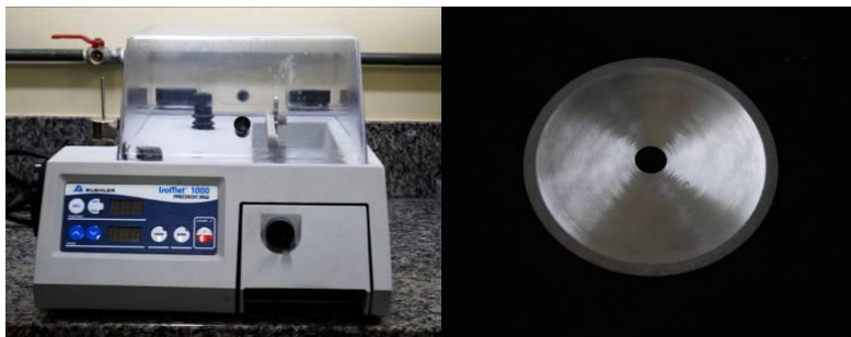
Fig. 2. A- Cortadeira metalográfica de precisão (Isomet 1000, Buehler, Illinois, EUA); B - Disco diamantado de alta concentração (4 "x 012 x 1/2, Buehler, Illinois, EUA).
