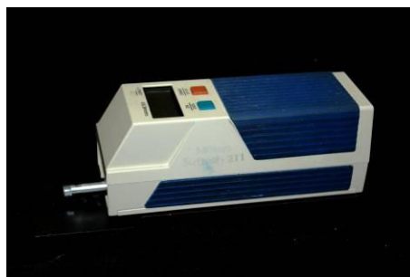
Fig. 5. Rugosímetro perfilômetro (Mitutoyo, Surftest 211; São Paulo, Brasil)
