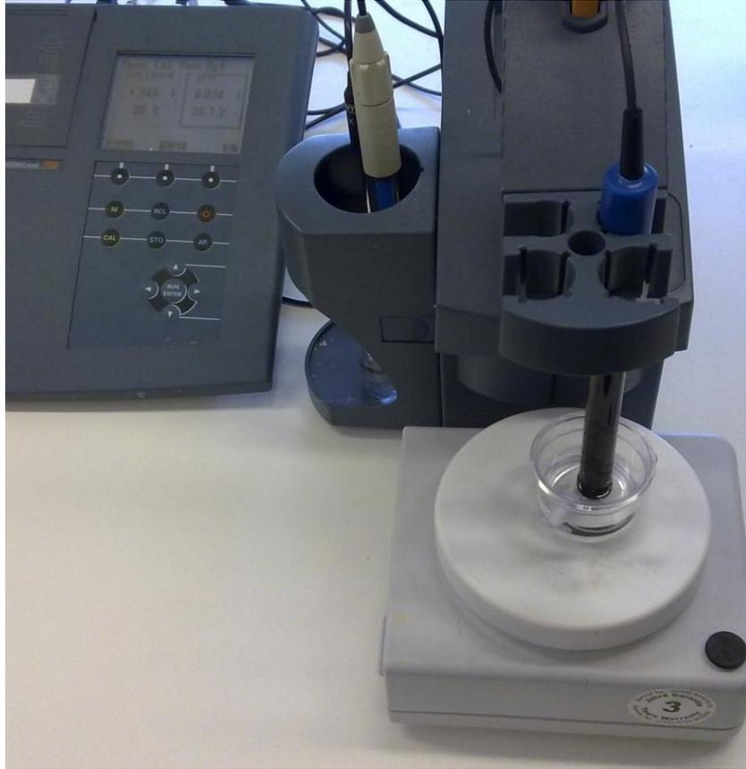
Fig. 5 – sondas para medir pH e liberação de íons cálcio.
