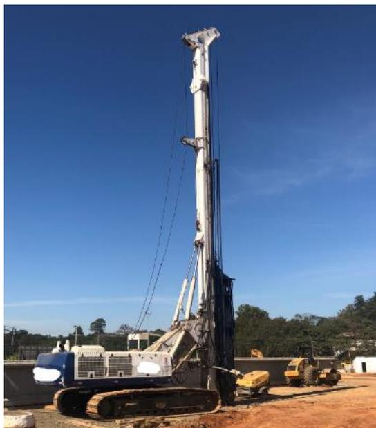
Figura 8: Máquina Bate Estacas 1. Foto própria, 2020.
