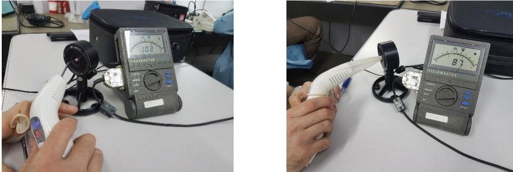
**Figura 5:** A. Teste de potência de saída do aparelho Therapy EC sem proteção; B. Teste de potência de saída com preservativo não lubrificado.
