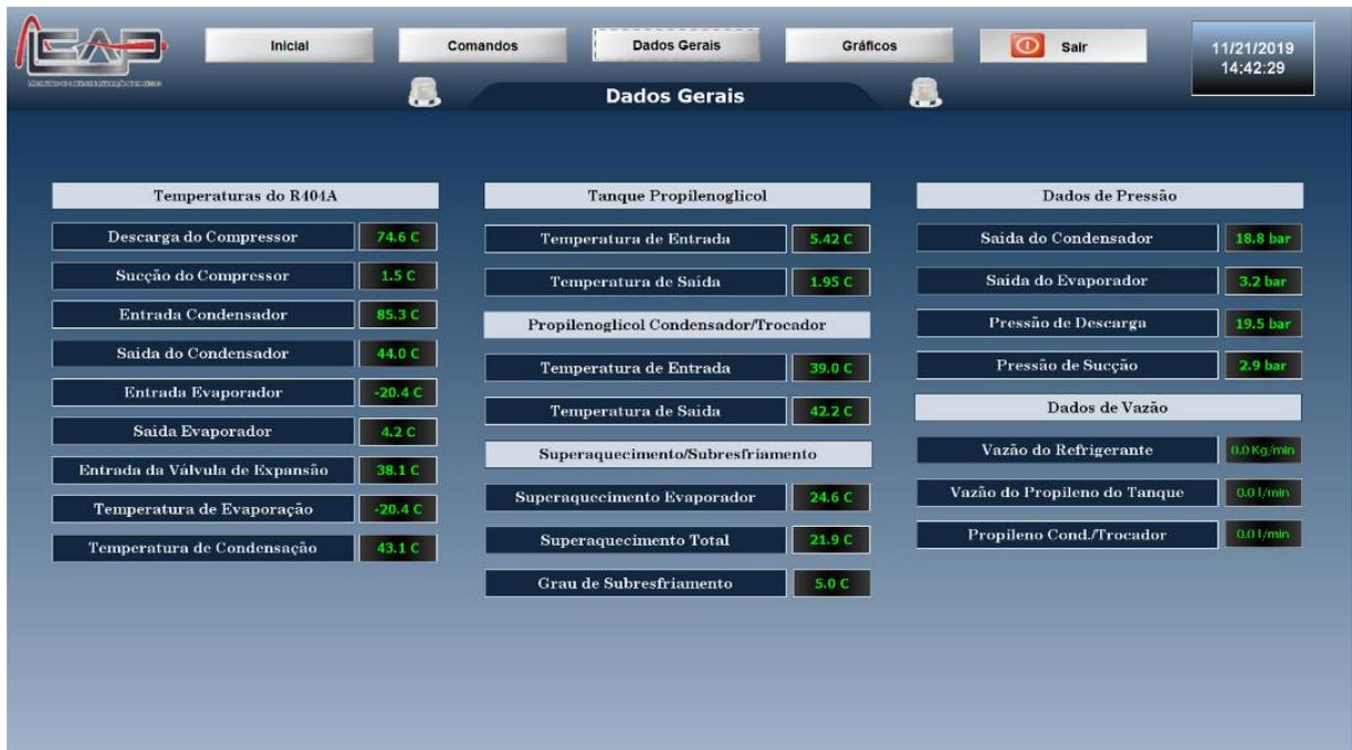
**Figura 19:** Tela de supervisão com os gráficos das principais variáveis da planta de refrigeração.
