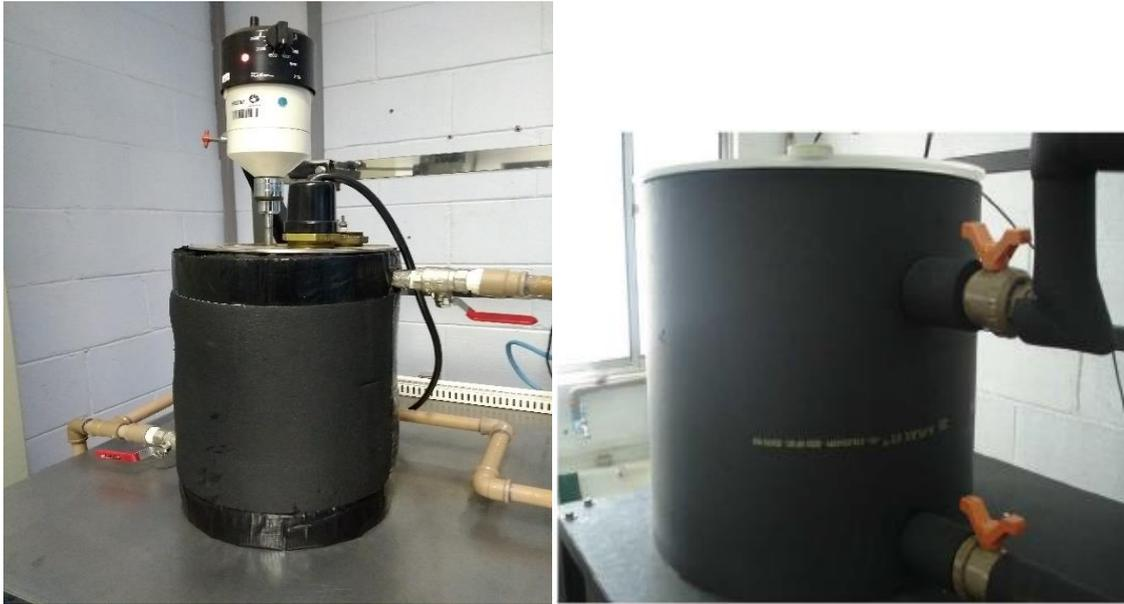
Encontrou-se problemas também na medição das vazões da solução de propilenoglicol que circula no evaporador, da vazão mássica de refrigerante e do consumo energético. O medidor de vazão do tipo turbina, disponível para medição da vazão da solução de propilenoglicol apresentou defeito, pois o sinal fornecido pelo mesmo possuía sempre o valor de 4mA, que seria o encontrado no caso de não houver circulação da solução de propilenoglicol.
