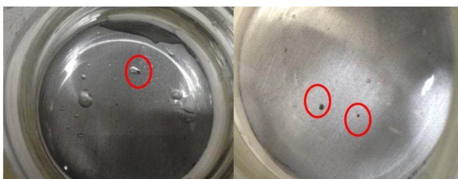
Figura 22 – Defeitos observados no filme e no substrato nas amostras F4 após realização do ensaio.
