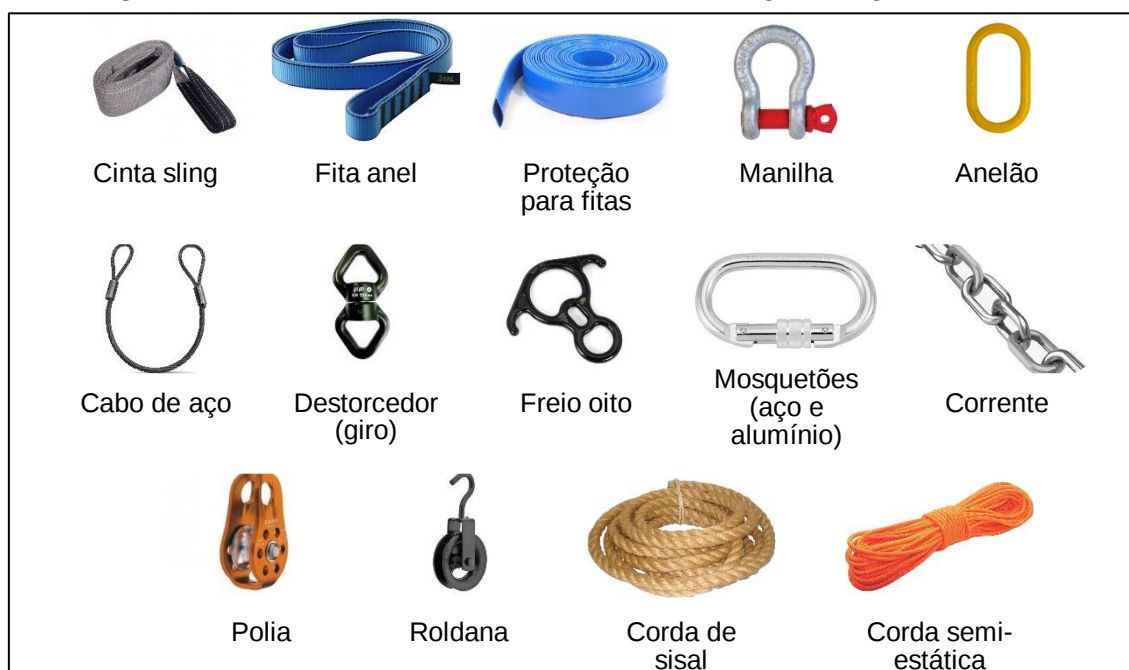
Quadro 2 - Materiais identificados nas ancoragens registradas 9 .
