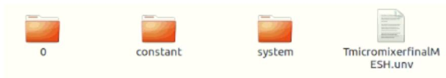
Figura C1. Estrutura de um diretório de simulação do caso em OpenFOAM.
