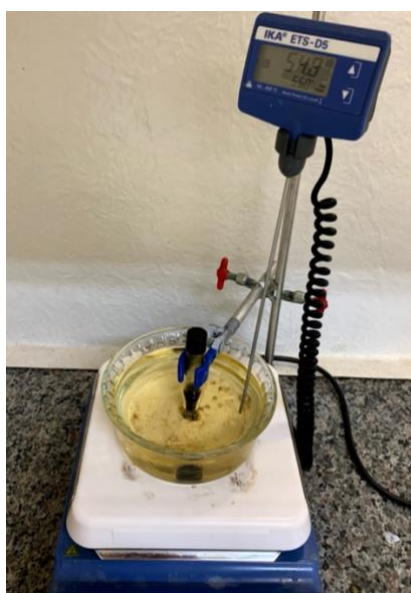
Figura 19 – Sistema utilizado para produção de lipídios funcionais por via enzimática.
