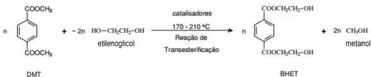
**Figura 1.** Transesterificação do DMT para obtenção do BHET.
