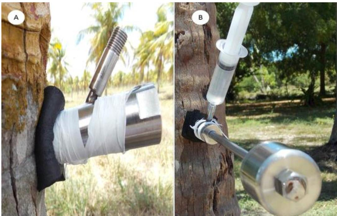
**Figura 17** – Réplica do equipamento para a infusão dos agrotóxicos. A) e B) Perfil do equipamento de infusão no estipe do coqueiro em diferentes outros ângulos.
