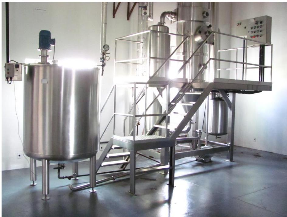
Fotos: Luis Ribeiro, Unidade de Produção de Extratos de Fitoterápicos da Produtores Associados para Desenvolvimento de Tecnologias Sustentáveis (Sustentec), destaca-se abaixo o *spray dryer*, Pato Bragado-PR (28/10/2011)
