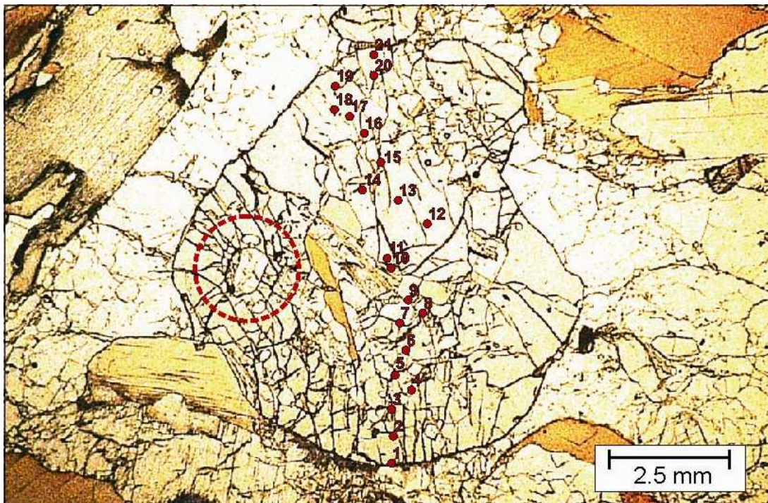
Figura 7: Imagem de granada (amostra WT8-07) com os pontos em perfil analisados em microsonda eletrônica. Destaque para a inclusão com fraturamento radial típica feição de quartzo \beta
