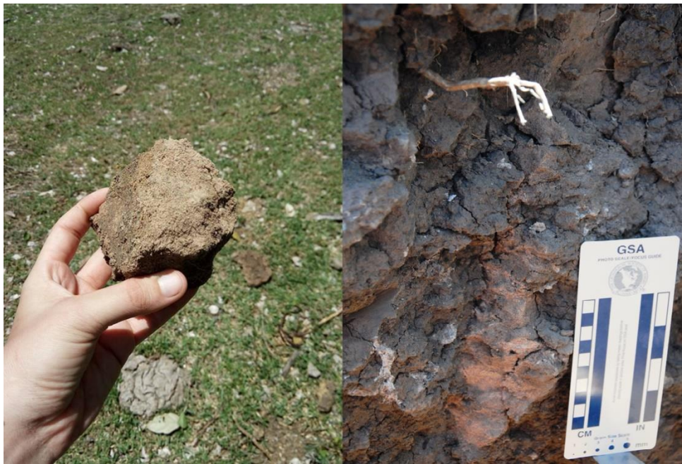
Figura 35: Películas de areia recobrimdo os peds no horizonte Bg1 e Bg2.
