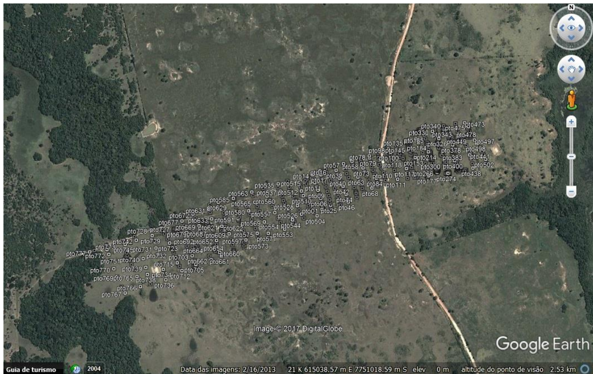
Figura 15: Distribuição dos 778 pontos de levantamento planialtimétrico.
