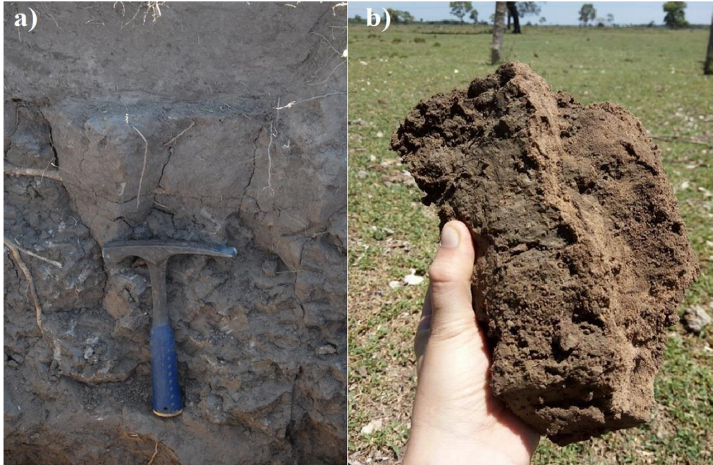
Figura 42: Em (a), estrutura colunar em horizonte Bt1. Em (b), estrutura prismática preenchida por areia no horizonte 2Bvn1.
