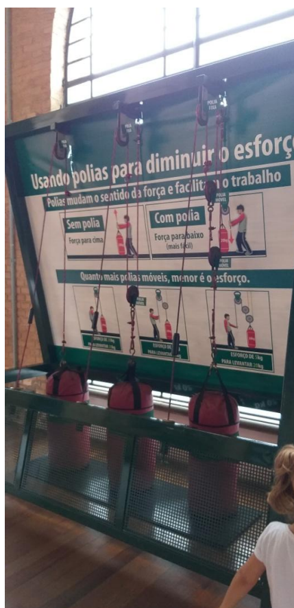
Figura 5. Atividade na sessão Engenharia apresenta o princípio mecânico de funcionamento das polias.
