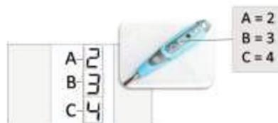
Para as placas locais (L1, L2 e L3) a caneta leitora primeiramente mostra os valores atuais. Se o valor mostrado está em branco, a caneta leitora se conecta com a placa principal e lê o respectivo valor em seu display. Se o valor exibido também for em branco, a caneta leitora mostra **nada** no display.
