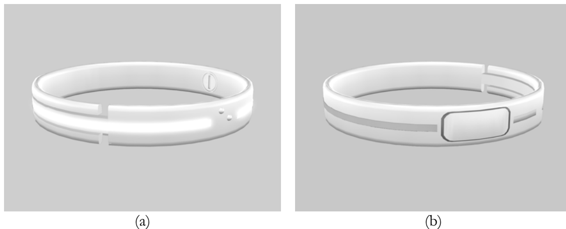
Figura B.26: Última versão do AIR-E com alguns destaques. (a) AIR aceso, marca Braille, acesso a bateria e ajuste mecânico (b) AIR apagado e botão
