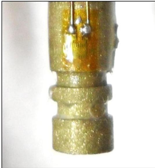
Figura 8 - Extensômetro posicionado e fixado na cervical do análogo.
