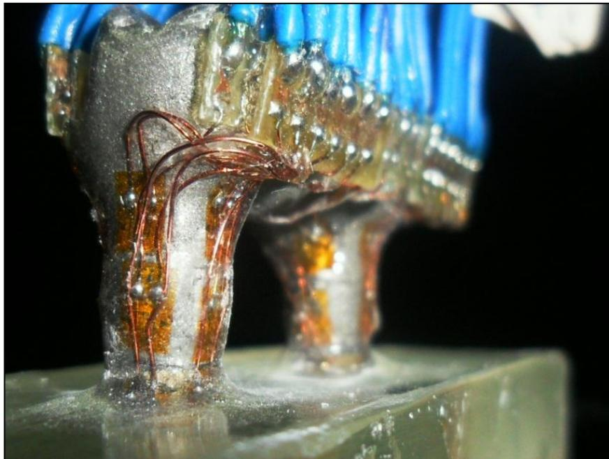
Figura 20 - Corpo de prova finalizado com os extensômetros fixados.
