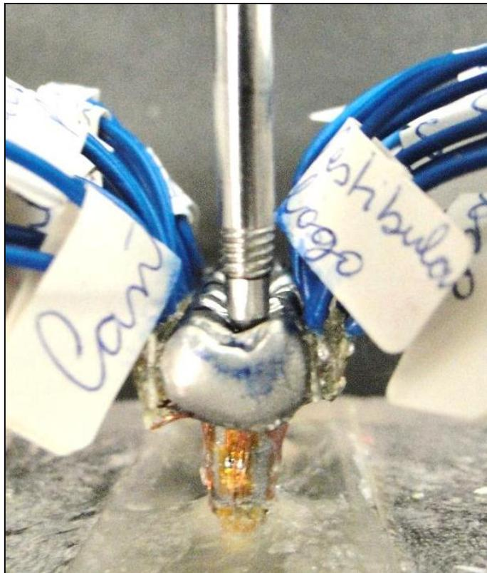
Figura 24 – Vista lateral da ponta aplicadora de carga sobre o corpo de prova.
