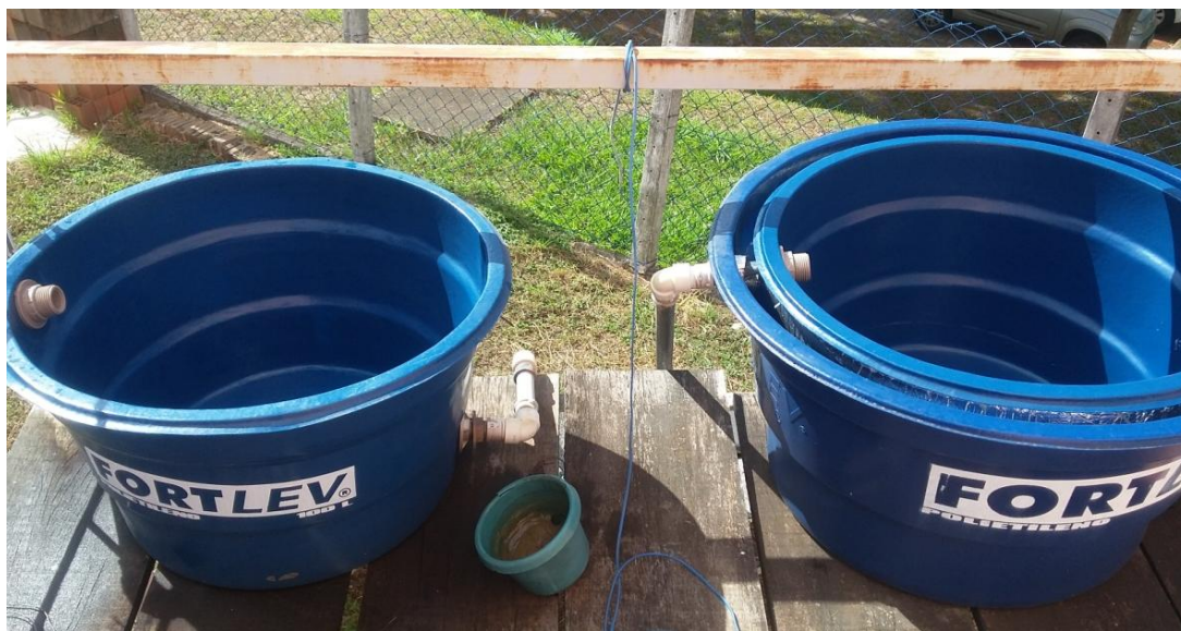
Figura 18: Foto do segundo par formado pelo protótipo de referência (esquerda) e o protótipo caixa revestida com manta de 10 mm embutido na caixa de 150 l.
