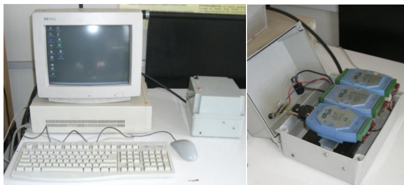
Figura 20: a) Equipamento utilizado para aquisição de dados de temperatura, com destaque para o NAP7000D. b) Planilha Excel para gravação das leituras
