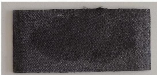
Dadas as placas produzidas, após corte, foram gerados dois corpos de prova nas dimensões consideradas. Para cada condição do planejamento experimental, foi necessária a produção de 3 placas com 5 camadas cada.
