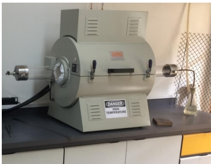
Figura 7- Forno montado para o crescimento do nanotubos de carbono.
