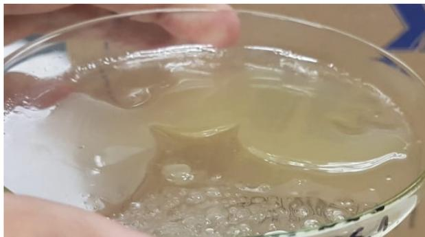
Após a volatilização em temperatura ambiente, as amostras foram submetidas a estufa de secagem em 45°C por 48 horas. Com o intuito de remover todo o resíduo do processo. A amostra seca pode ser avaliada pela Figura 5.3.
