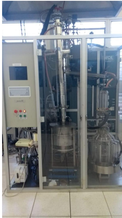
Figura 18: Foto tirada pelo autor da planta de destilação D2892 da GECIL localizada no laboratório VALPET da Universidade Estadual de Campinas.
