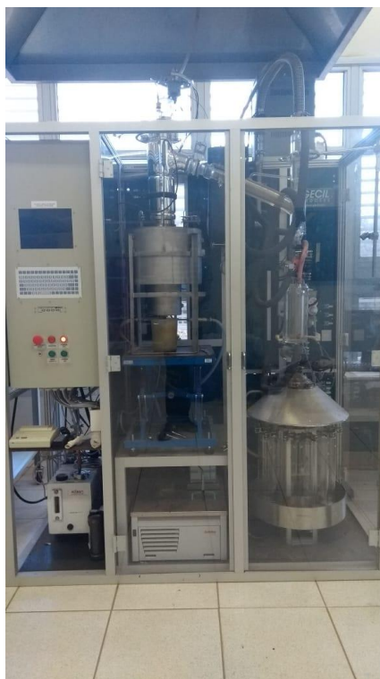
Figura 22: Foto tirada pelo autor da planta de destilação D5236 da GECIL localizada no laboratório VALPET da Universidade Estadual de Campinas.
