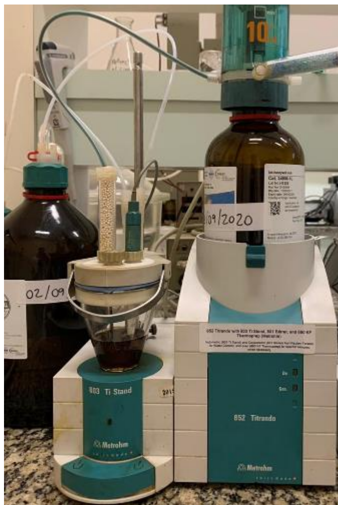
Figura 4: Titulador Karl Fischer Coulométrico 852 Titrande com 801 Stirrer da Metrohm localizado no VALPET da UNICAMP.
