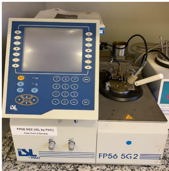
Figura 5: Analisador automático FP56 5G2 da ISL localizado no VALPET da UNICAMP.
