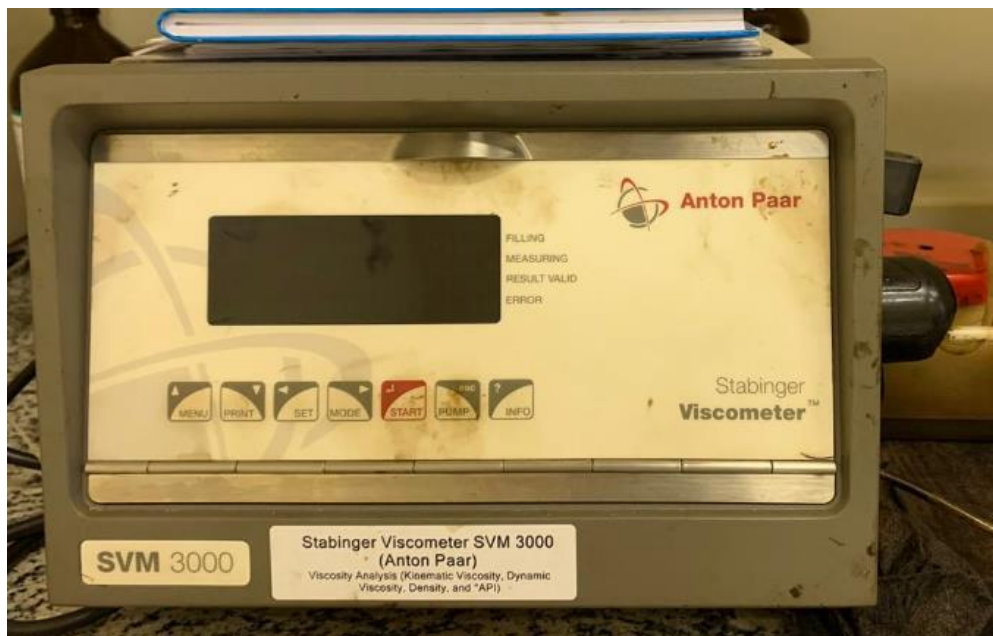
Figura 3: Viscosímetro Stabinger SVM 3000 da Anton Paar localizado no VALPET da UNICAMP.
