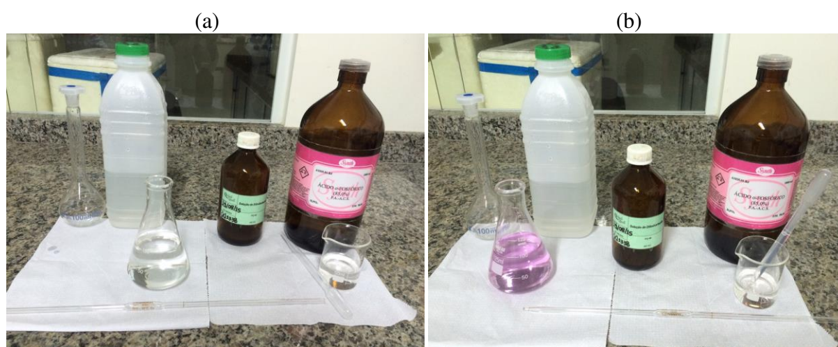
Figura 2.5 Preparo da amostra para a análise do cromo hexavalente (a) e amostra rosada após reação de cor (b)
