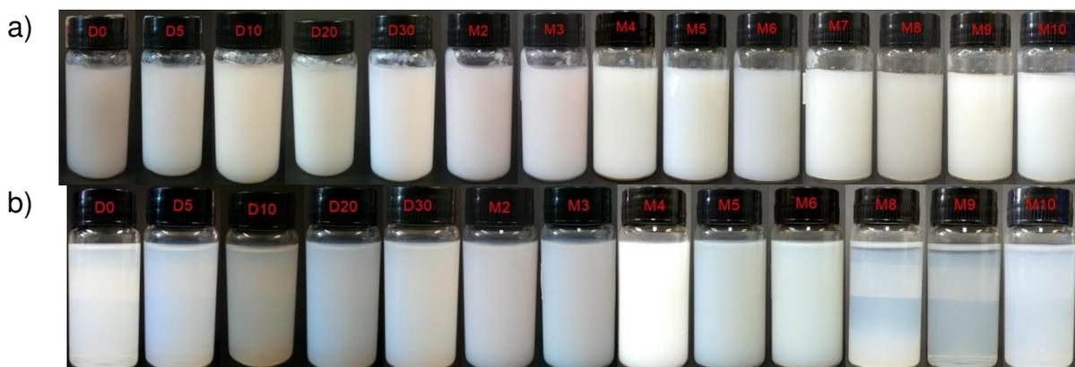
**Figura 5.21:** Avaliação da estabilidade do látex pela observação visual de separação de fase. Experimentos G4: a) A5MF\_1 e b) A5NC\_1
