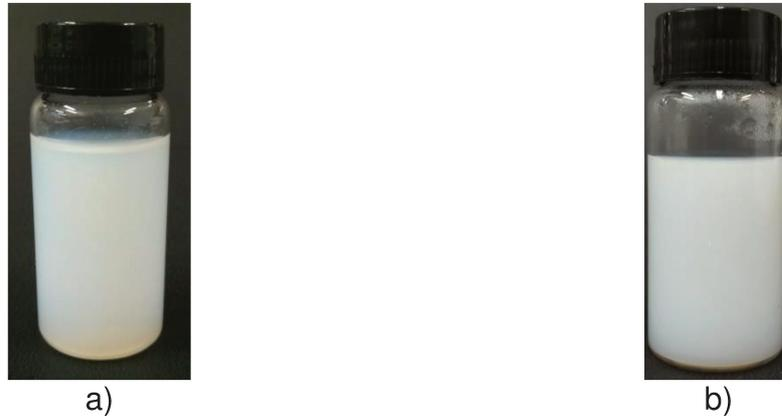
**Figura 5.8:** Intensa deposição de material com formação de um bloco sólido de material para a reação A5NC\_1
