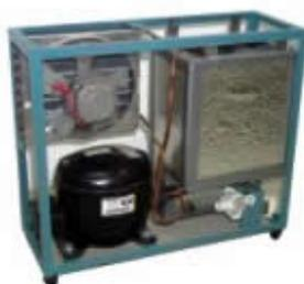
Figura 3. 8 – O Chiller empregado no Sistema ELI (RANGE LASER, 2006).
