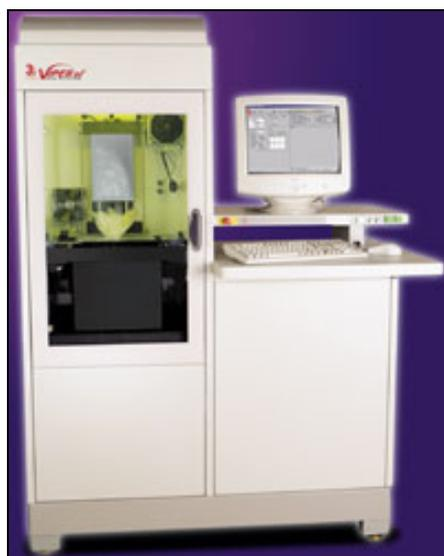
**Figura 1.2 – Sistema SL comercializado pela empresa 3D Systems.**
