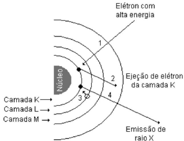
**Figura 5 - Ilustração de emissão de raios-X por um átomo ao incidir sobre o mesmo um elétron de alta energia (TUCKER, 2003)**
