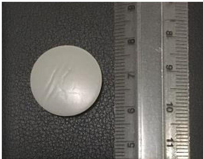
**Figura 4.1.2b: Septo de silicone revestido com PTFE**
