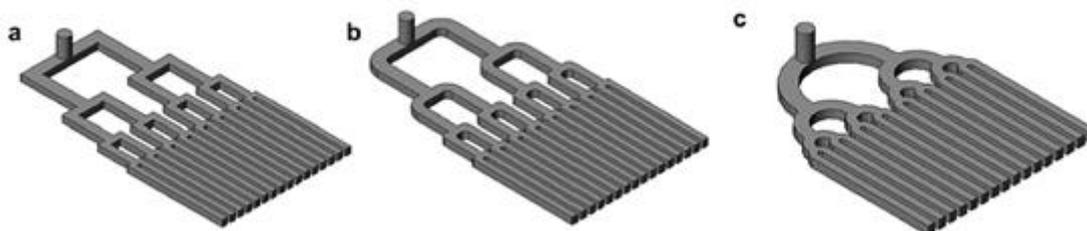
Figura 5. Canal de fluxo do tipo bifurcação com a) canto com quinas, b) canto arredondado e c) circular. Adaptado de Liu et al., 2010.
