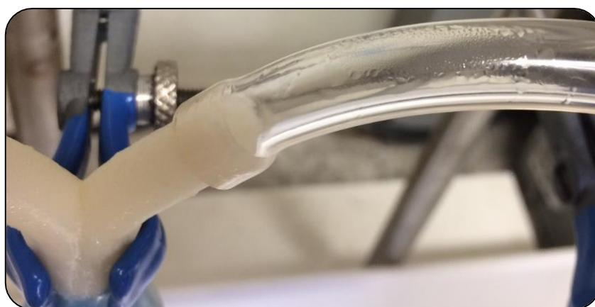
Figura 36. Evaporação de etanol na tubulação de entrada do distribuidor.
