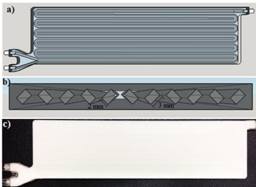
Figura 22. Milirreator para a síntese de biodiesel: a) vista superior dos canais no SketchUp; b) vista da seção transversal do canal retangular com dimensões; c) vista superior da peça fabricada em impressora 3D.
