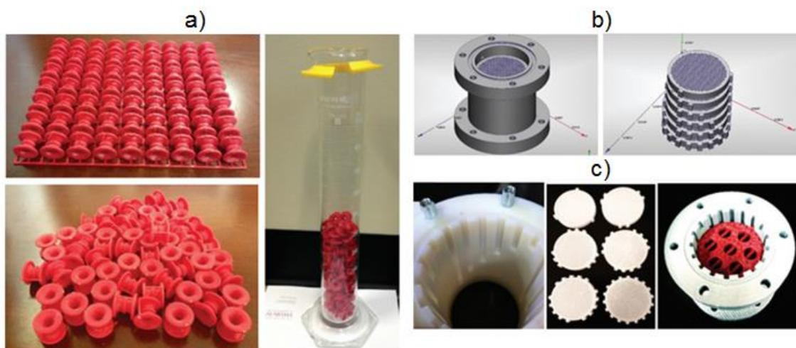
Figura 13. Dispositivos desenvolvidos para absorção de CO<sub>2</sub>: a) anéis híbridos fabricados a partir do polímero ABS, por meio de impressora 3D, b) design da coluna de pratos no programa SolidWorks e c) corpo e pratos da coluna fabricados em impressora 3D. Adaptado de Bara et al., 2013.
