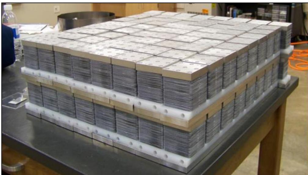
Figura 1. Visão geral de 18 *manifolds* (7200 microdispositivos) da microplanta utilizada na produção de biodiesel. Fonte: Billo et al., 2015.
