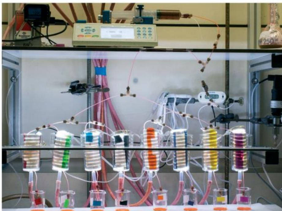
Figura 9. Sistema de escalonamento com 8 microrreatores capilares. Fonte: Su et al., 2016.
