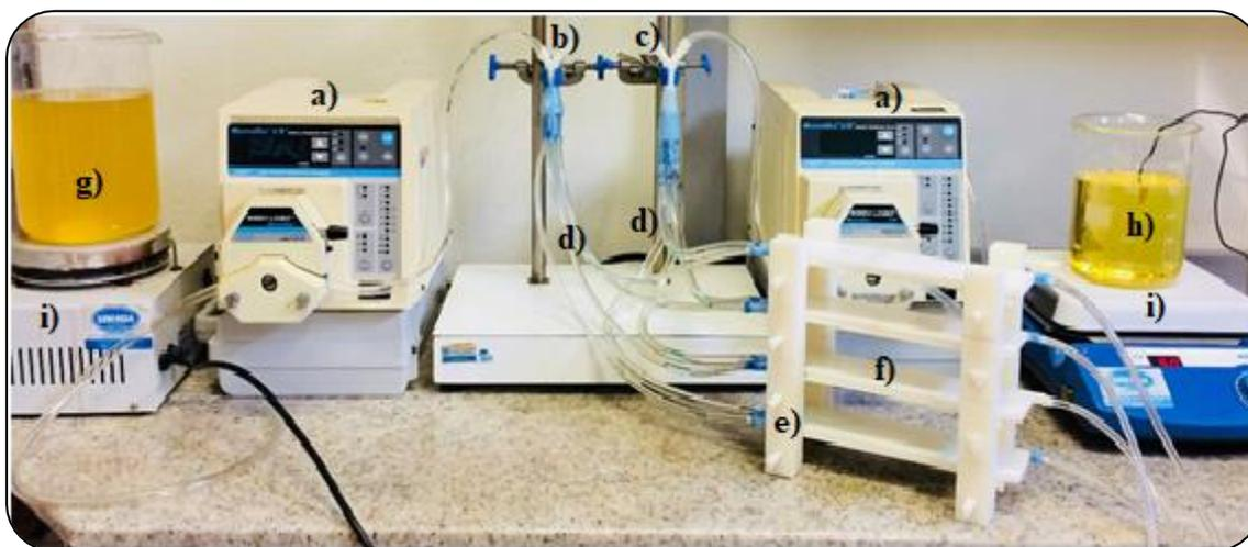
Figura 26. Microplanta para a produção de biodiesel: a) bombas peristálticas; b) DCS26; c) DCO52; d) tubulações flexíveis Tygon; e) estrutura de suporte; f) milirreatores; g) solução etanol e hidróxido de sódio; h) óleo de girassol; i) chapas de aquecimento.
