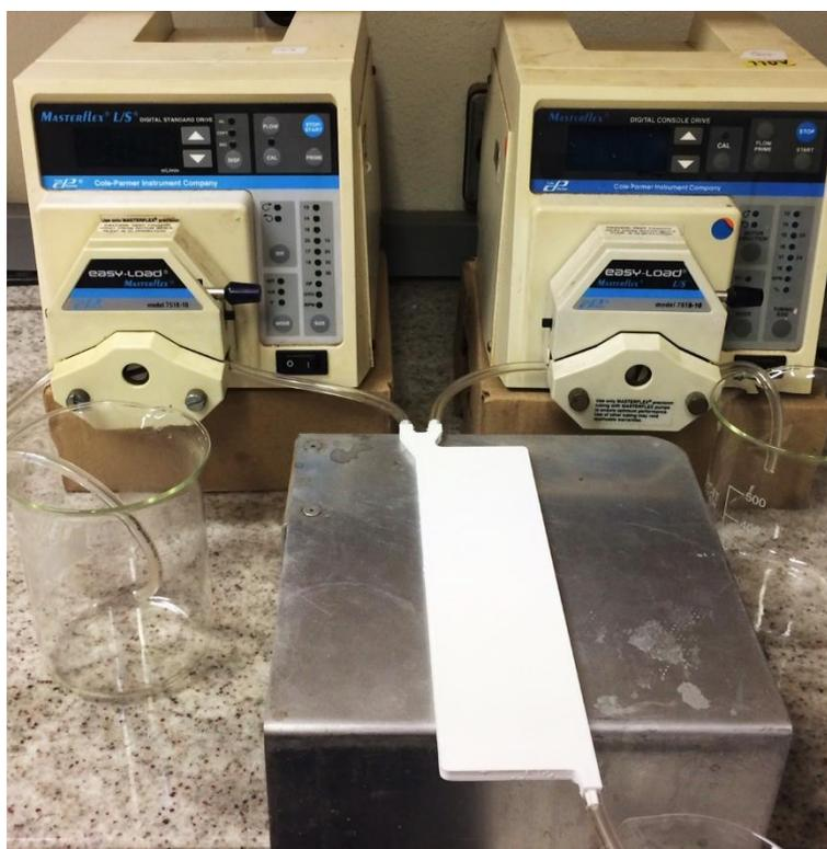
Figura 25. Aparato experimental geral utilizado nos ensaios de reação no milirreator.
