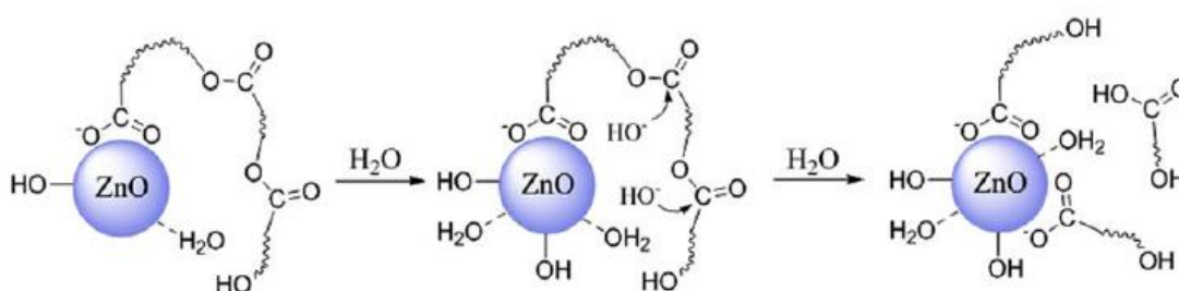
Figura 39 – Esquema da hidrólise catalisada pelo ZnO (reproduzido de Qu et al. , 2014)
