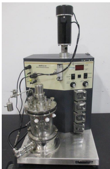
Figura 2.1 – Biorreator BIOFLO III de 3 L (New Brunswick Scientific Co, Inc, Edison, NJ, EUA) utilizado nos cultivos com valores fixos de vazão de oxigênio e taxa de agitação.
