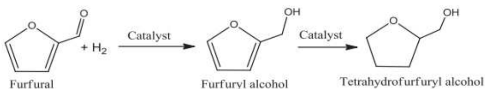
Figura 6: Hidrogenação do furfural a álcool tetraidrofurfurílico
