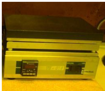
Figura 3.6. Placa aquecedora ( Hot Plate Tecnal , modelo TE – 018) (RICCHI, 2013) (LNNano/CNPEN/LNLS).
