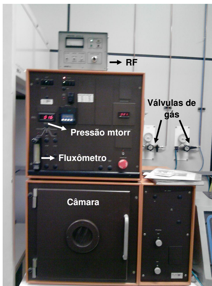
Figura 3.3. Equipamento de plasma de rádio frequência (RF) Barrel Asher (LOPES, 2012).
