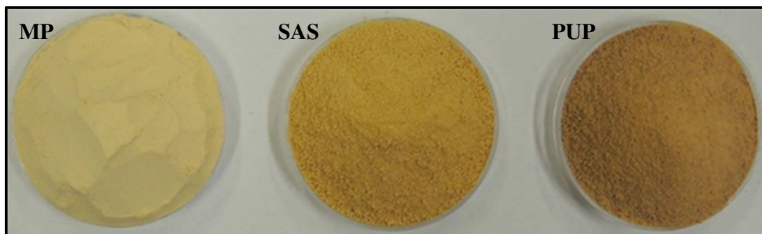
Figura 4.90: Fotografia da matéria-prima (MP) e dos pós aglomerados na COP para cada ligante.
