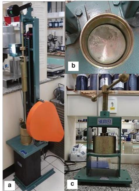
(a) Prensa elétrica Marshall; (b) Cilindro de compactação; (c) Descompactador Marshall
