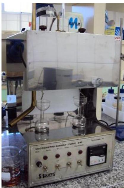
Figura 9 - Fotografia de um equipamento Saybolt/Furol
