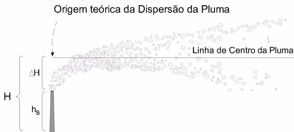
Figura 2-7: Ilustração da altura da pluma de dispersão
