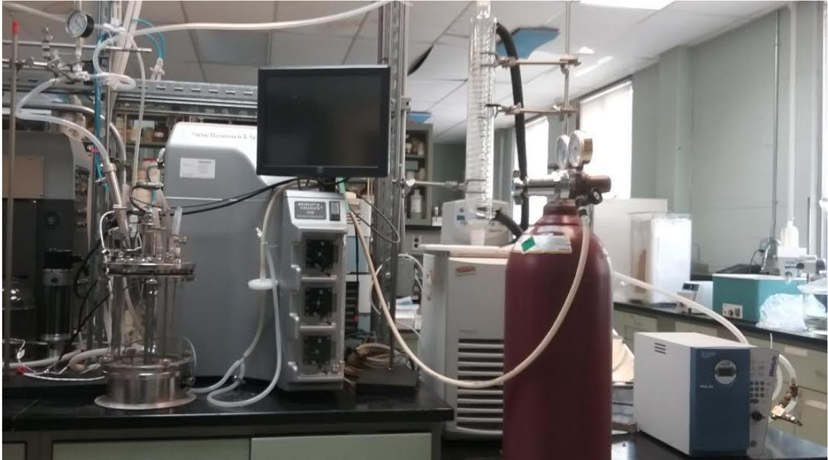
**Figura 27:** Aparato experimental utilizado nos ensaio de extração e fermentação com aplicação de vácuo, composto por biorreator e sistema supervisorío e suporte de bombas peristálticas de alimentação; balão de coleta de etanol extraído; sistema de condensação (condensador espiral e banho termostático com etileno glicol); Bomba a vácuo; armadilha de água para absorver o etanol não condensado e cilindro de gás nitrogênio.
