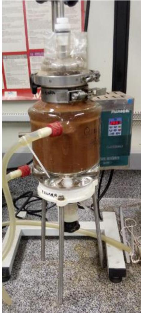
**Figura 20:** Reator utilizado para a reação de hidrólise enzimática
