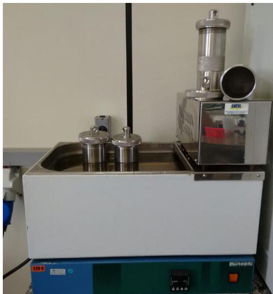
**Figura 15:** Reator em aço inox e banho termostático utilizados para reações a temperaturas superiores a 121°C (Agradecimento a LEPFE).
