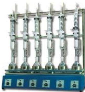
**Figura 53:** Sistema soxhlet para realizar a extração de material não estrutural.
