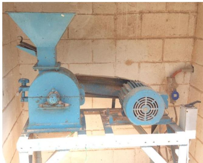
**Figura 7:** Moinho de martelos e motor de indução de 3800 rpm utilizado para processar o eucalipto
