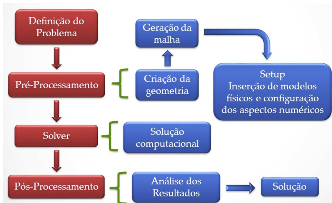
Figura 15: Fluxograma da metodologia da construção de projetos em CFD (adaptado de ANSYS, 2016).
