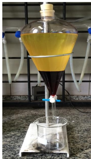
Figura 4.12 – Fotografia de uma etapa de lavagem do estireno.
