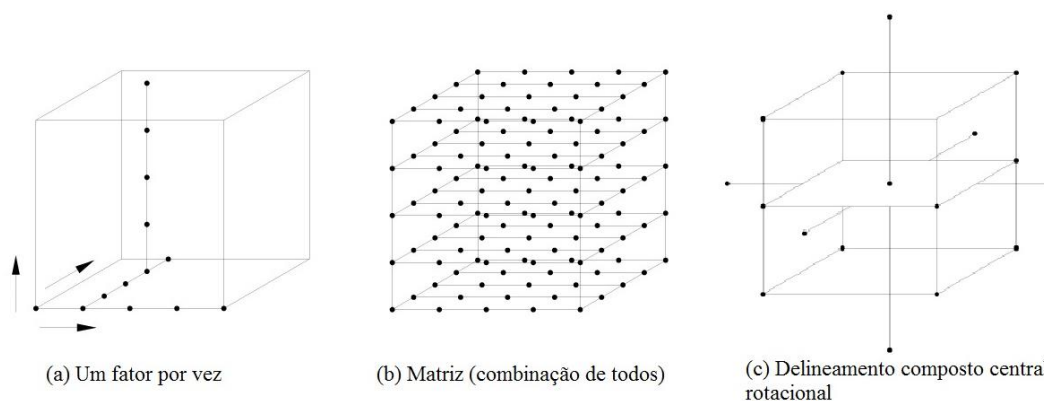
Figura 2. 9 Possibilidade de conduzir experimentos para 3 variáveis estudadas. (a) Análise de uma variável por vez, (b) Matriz com todas as combinações possíveis e (c) Delineamento composto central rotacional (DCCR). FONTE: HAALAND (1989), adaptado de RODRIGUES e IEMMA (2005).
