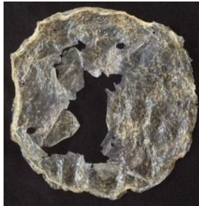
Figura 4.3 – Aspecto visual da membrana de quitosana-alginato contendo 0,20 g/g de PDMS.
